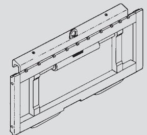
**DOSSERET DE CHARGE (SUR TABLIER INCLINABLE TI)**
